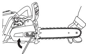
При установке новой цепи следует часто проверять ее натяжение, пока цепь не проработает. Регулярно проверяйте натяжение цепи. Правильно натянутая цепь обеспечивает высокое качество пиления и дольше служит.
