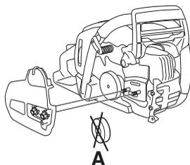
Установите пильное полотно на специально предназначенные болты. Установите полотно в самое заднее положение. Наденьте цепь на ведущую звездочку и вставьте ее хвостовики в паз пильного полотна. Начинать с верхней стороны пильного полотна.
