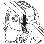
Остановка двигателя осуществляется нажатием на выключатель запуска/остановки.
