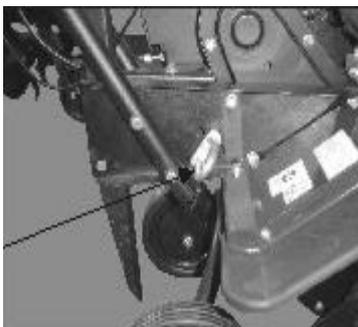
Колеса закреплены на культиваторе замком. Для изменения позиции потяните за замок и измените положение опорных колес до необходимого положения. Отпустите замок.
