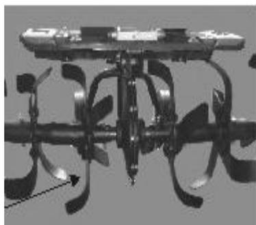
После работы культиватор необходимо почистить. Прочистите фрезы, промойте водой и протрите ветошью. Запрещается использовать для очистки культиватора, и особенно редуктора, струю воды под давлением. Отчистите двигатель щёткой или ветошью.
