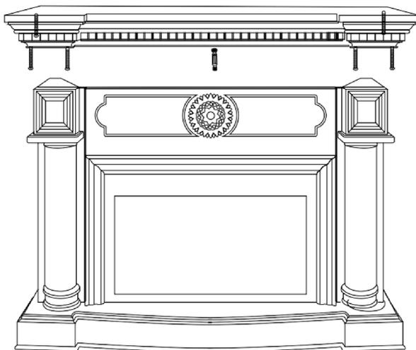
Закрепить верхнюю часть портала Е при помощи винтов и эксцентриковых стяжек, к передней панели D и к колоннам С и В.
