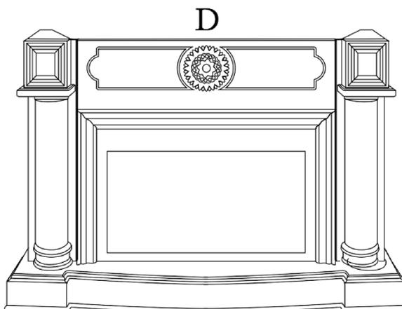
Установить переднюю панель портала D при помощи винтов.
