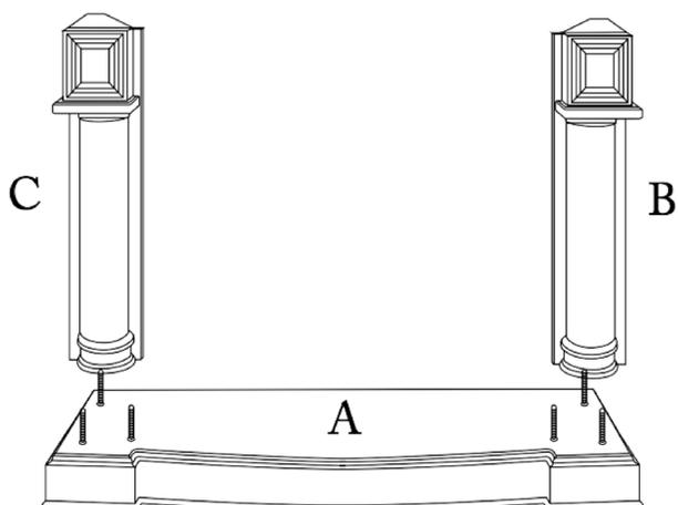
На основание портала A, при помощи винтов установить боковые колонны C и B.
