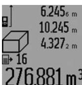
Чтобы вызвать сохраненные в памяти значения измерений, нажмите кнопку **15**. На дисплее отображается результат последнего измерения и индикатор списка измеренных значений **d**, а также счетчик с нумерацией измерений, отображаемых на дисплее.
