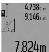
По окончании последнего измерения результат для искомого отрезка **«E»** отображается в строке результата **c**. Отдельные измеренные значения отображаются в строках измеренных значений **a**.
