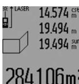
Затем измерьте длину **B<sub>1</sub>** первой стены. Площадь рассчитывается автоматически и отображается в строке результата **c**. Значение длины появляется в средней строке измеренных значений **a**.
