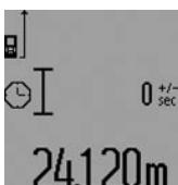
Затем нажмите кнопку измерения **7**, чтобы включить лазерный луч и навести инструмент на цель. Снова нажмите кнопку измерения **7**, чтобы дать команду измерения. Измерение выполняется по истечении заданного временного интервала. Измеренное значение отображается в строке результата **c**.
