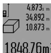
По окончании третьего измерения объем автоматически рассчитывается и высвечивается в строке результата **c**. Отдельные измеренные значения отображаются в строках измеренных значений **a**.
