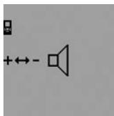
Для включения и выключения звукового сигнала нажмайте кнопку выбора режима **3** до тех пор, пока на дисплее не появится индикатор настройки звука. Нажмая кнопку «плюс» **6** или кнопку «минус» **12**, выберите необходимую настройку.
