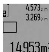
По окончании второго измерения значение площади автоматически рассчитывается и высвечивается в строке результата **c**. Отдельные измеренные значения отображаются в строках измеренных значений **a**.
