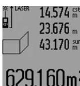
Измерьте теперь длину **B<sub>2</sub>** второй стены. Отображаемое в средней строке измеренных значений **a** значение прибавляется к длине **B<sub>1</sub>**. Сумма обоих значений длины («**sum**»), которая
