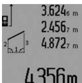
По окончании последнего измерения результат для искомого отрезка «**E**» отображается в строке результата **c**. Отдельные измеренные значения отображаются в строках измеренных значений **a**.
