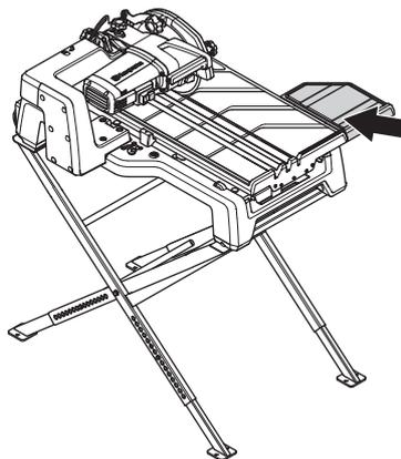
Если боковой стол не находится на уровне отрезного стола, выполните регулировку. Выполните регулировку с помощью винтов.
