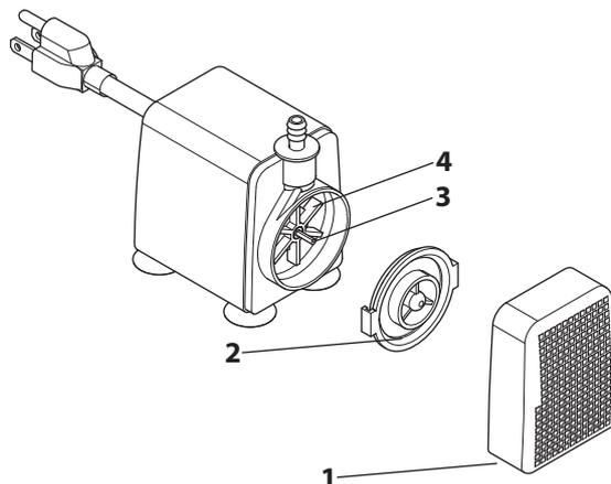
Kui magnetilise rootori võlli küljes on rauaosakesi, võib need lapiga eemaldada.
