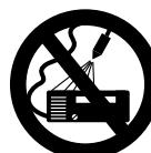
Sam uređaj i ostale električne uređaje nikada ne prskati visokotlačnim mlazom ili crijevom za vodu – **opasnost od kratkog spoja!**
