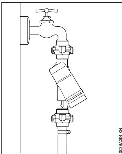
Kod priključka na mrežu vode za piće se između pipca za vodu i crijeva mora instalirati sprječavatelj povratnog toka/tijeka prema IEC/EN 60335-2-79.
