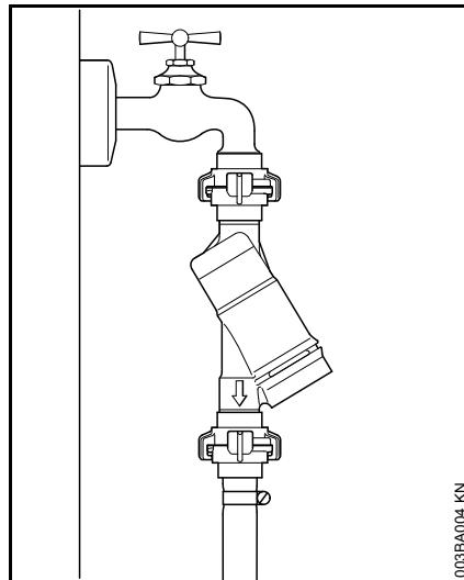
Kod priključivanja na mrežu pijaće vode između slavine za vodu i creva mora biti instaliran zaustavljač povratnog toka prema IEC/EN 60335-2-79.
