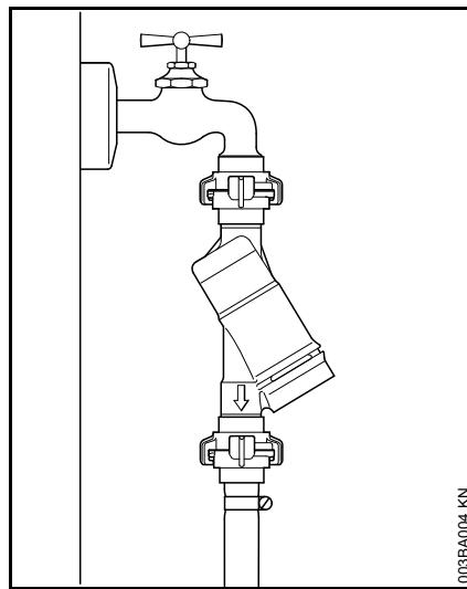
La racordarea la rețeaua de apă potabilă între robinetul de apă și furtun trebuie să fie instalată o supapă de return conform IEC/EN 60335-2-79.
