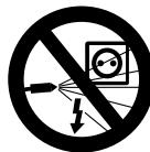
Električna postrojenja, priključke i strujne vodove ne prskati visokotlačnim mlazom ili crijevom za vodu – **opasnost od kratkog spoja!**
