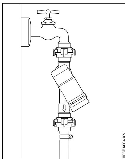
При подсоединении к сети снабжения питьевой водой между водопроводным краном и шлангом должен монтироваться возвратный клапан согласно IEC/EN 60335-2-79.
