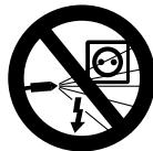
Nu stropiți cu jetul de înaltă presiune sau cu furtunul cu apă aparatele electrice, raccordurile și cablurile străbătute de curent – **pericol de scurtcircuitare!**
