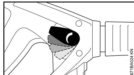
С помощью регулирующего рычага рабочее давление и кол-во подачи воды может регулироваться небольшими шагами.
