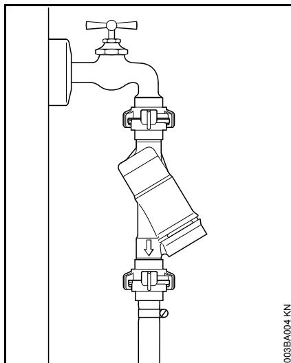
Przy podłączaniu do sieci wodociągowej wody pitnej, pomiędzy zaworem odcinającym dopływ wody a wężem należy zainstalować zawór zwrotny zgodny z normą IEC/EN 60335-2-79.
