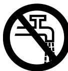
Nie należy podłączać urządzenia bezpośrednio do sieci wodociągowej wody pitnej.
