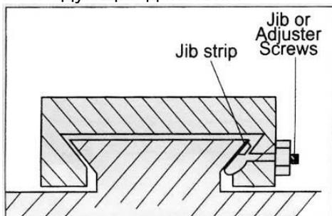
1. Равно ослабьте все стопорные гайки и винт на регулировочных винтах, т.е. используя одинаковое количество оборотов для каждого винта. Необходимо твердо держать салазки. Попробуйте, попытавшись повернуть рукоятку, но не прилагайте к ней усилий.
