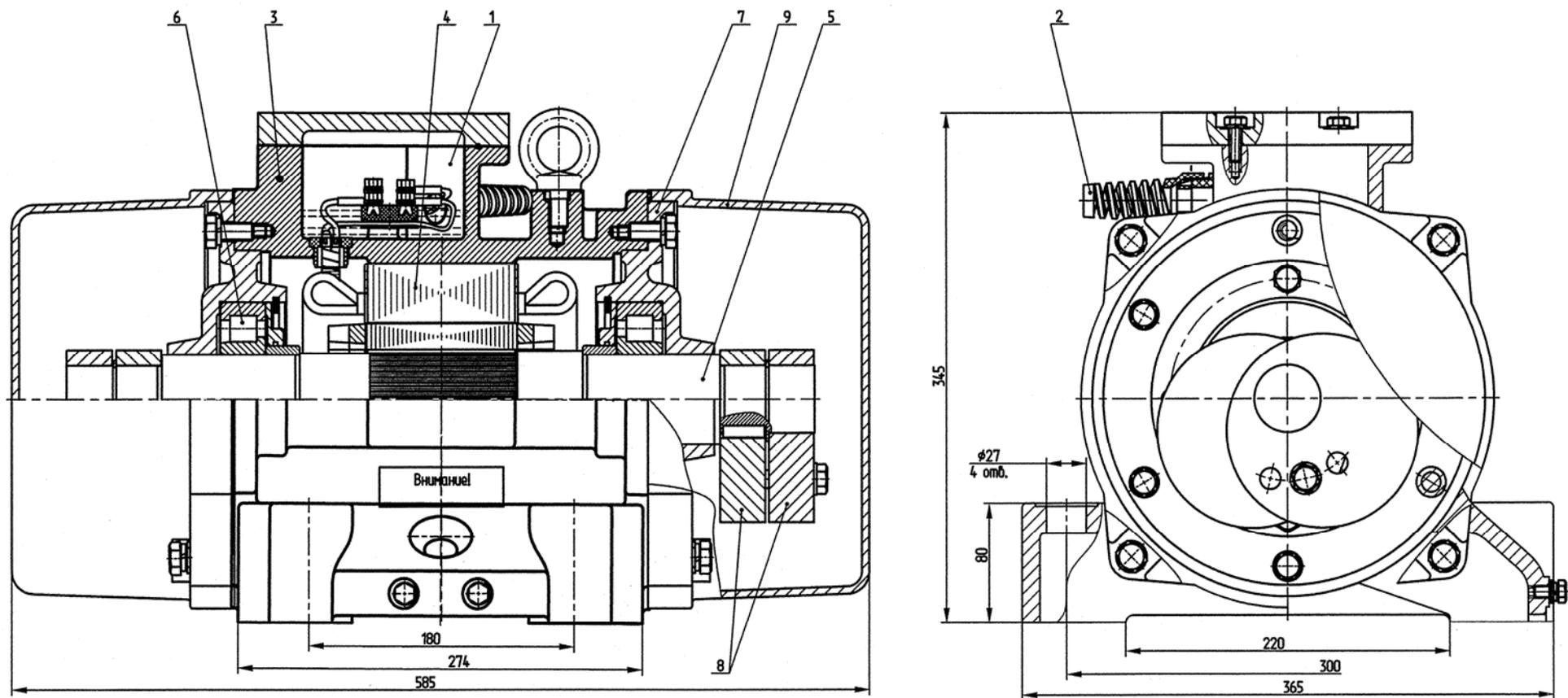
Рисунок 2. 1 – коробка выводов; 2- кабель выводной; 3 – станина; 4 – статор; 5 – ротор; 6 – подшипник;
