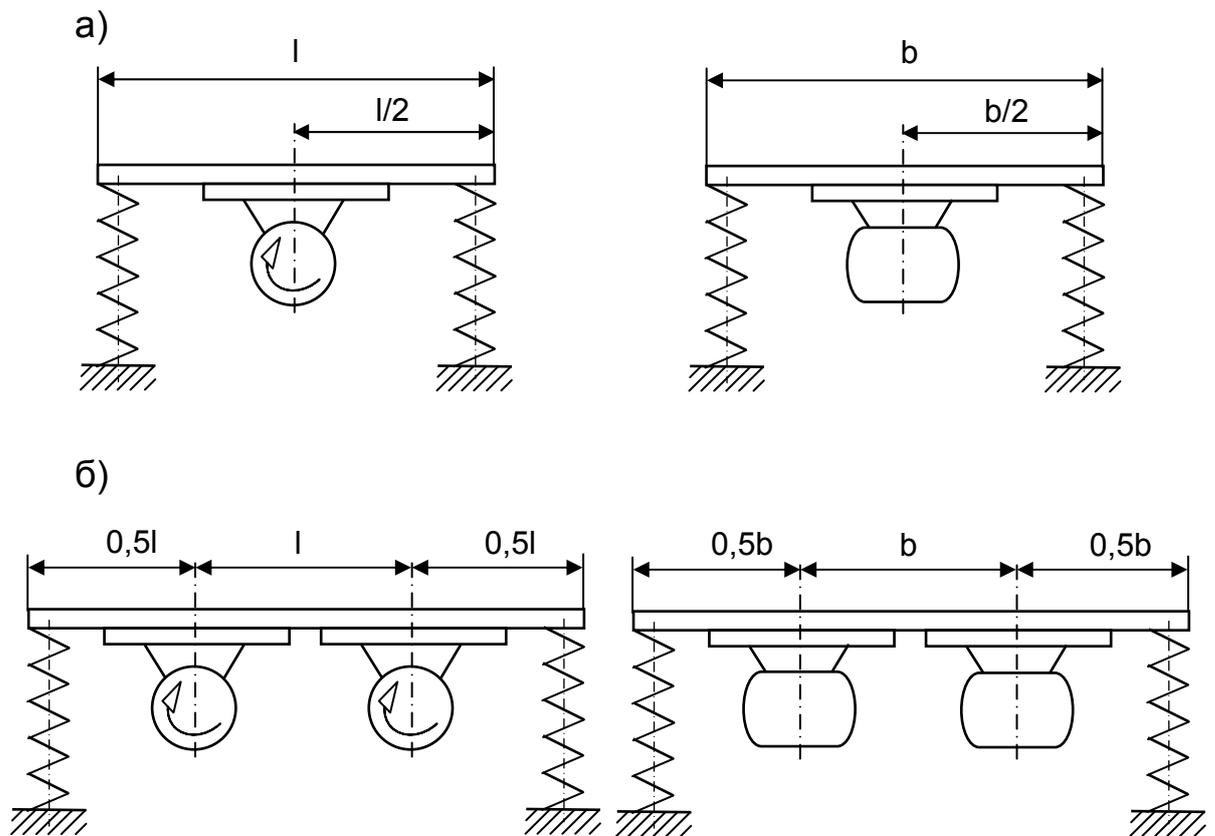
В случаях, когда техпроцесс требует направленных колебаний системы (прямолинейное транспортирование, ориентирование, забивание, трамбование и т.п.), однотипные вибраторы устанавливаются парами на одной опорной плите с параллельными противоположно вращающимися валами.
