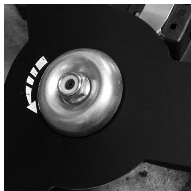
Крепление режущего диска: совместите отверстие в ступице вала с отверстием в чашке редуктора.
