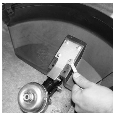
Состыкуйте отверстия в защитном кожухе с отверстиями в планке крепления. Закрепите защитный кожух гайками с обратной стороны, как на фотографии.
